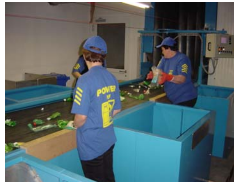
Handsartierung nach einer elektronischen Sortierung als Inspektorlösung
