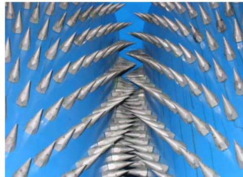
Blick auf den Rotor eines PET-Perforators
