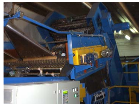
Kleinteilabscheide- und Beschleunigungssieb
