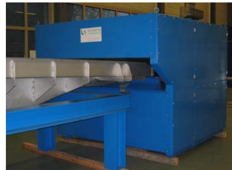
Grossteil- Labelabscheider Borema-GTLA
